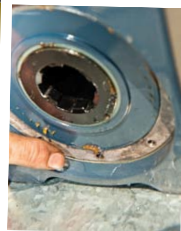
Из некоторых лебедок, через сливные отверстия стекала вода, набранная во время испытания.
